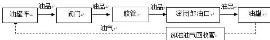
图 2.5-3 汽油卸油工艺流程图
