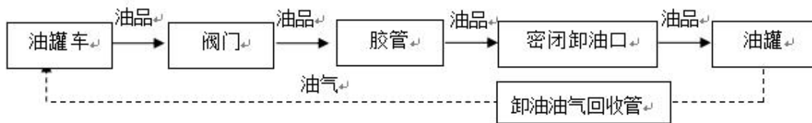
图 2.6-3 汽油卸油工艺流程图
